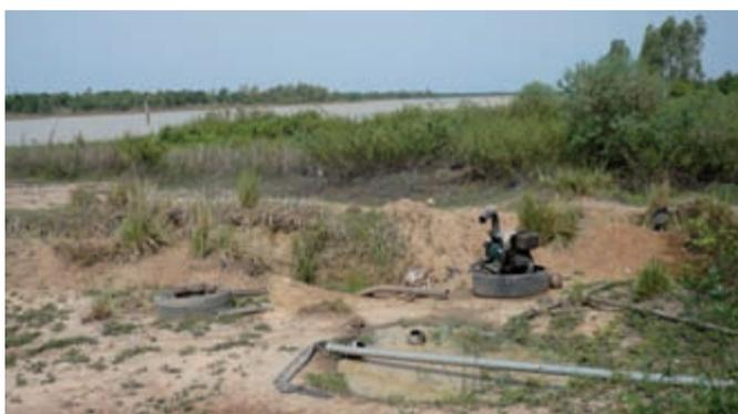
**Figure 5: Pompe à moteur retirant l'eau d'un fossé creusé près du petit réservoir pour l'irrigation sur les digues.**
